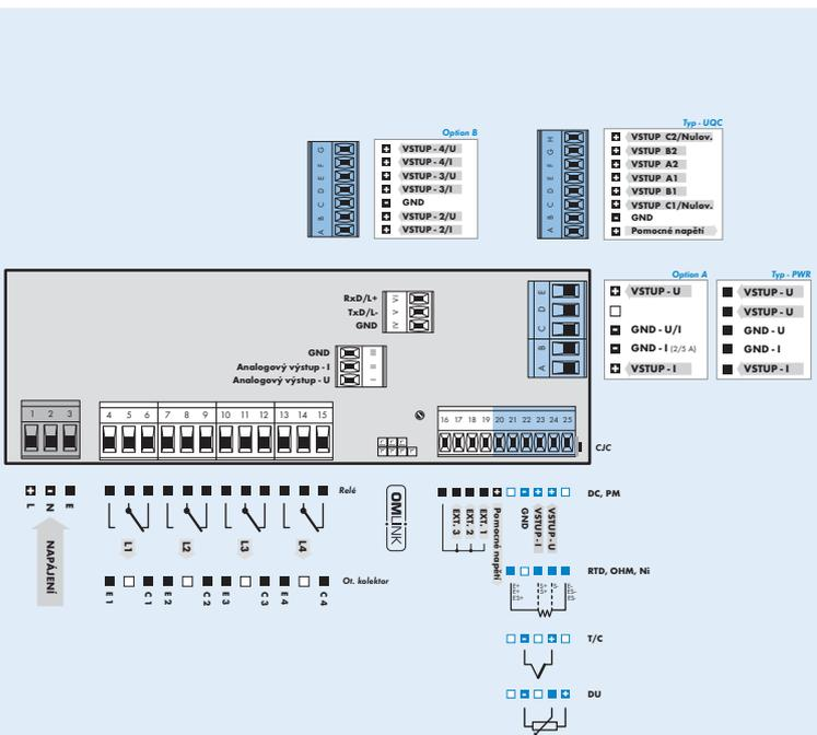
\*GND (Option A) je galvanicky spojené s vstupy EXT. a konektorem OM Link
